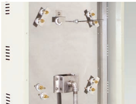
Doble cámara interior: Una en acero inoxidable y otra con aislamiento térmico en cerámica de alta densidad.
