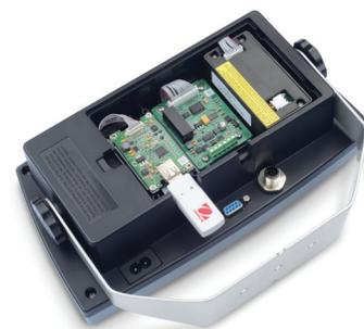
Utilizando la opción analógica (4-20mA o 0-10V) o las dos entradas y cuatro salidas de E/S discretas, el nuevo indicador de Defender 5000 también se puede utilizar para sistemas con PLC.
