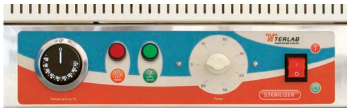
Control analógico con termostato hidráulico tipo Robert Shaw.
